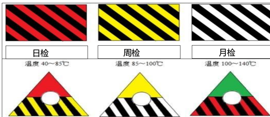
图 5-3 设备测温标准图
