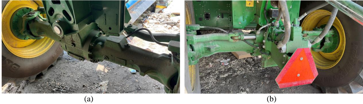
图 1-2 现有采棉机后驱动桥 (a)前侧图, (b)后侧图
