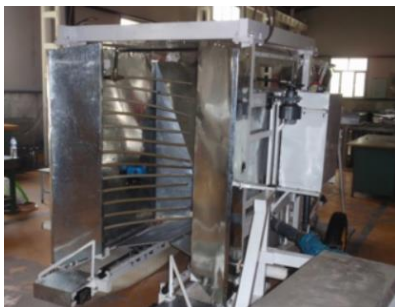
图 1-4 高丛蓝莓收获机 Fig.1-4 Highbush blueberry harvester
